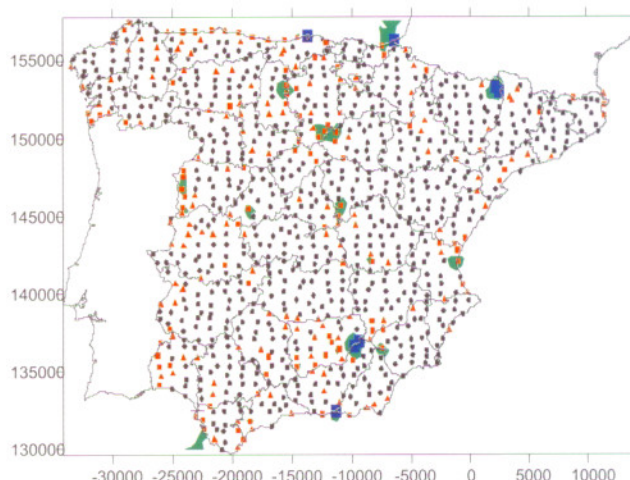
Figura 10.- Detección de errores groseros en longitud. A la derecha en latitud
