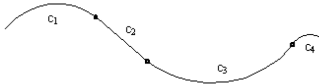
Figura 6. Línea definida como una serie de valores constantes de curvatura ( c_n )
