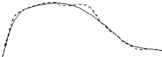
Figura 9. Detalle de generalización con arcos cúbicos con un buen ajuste
