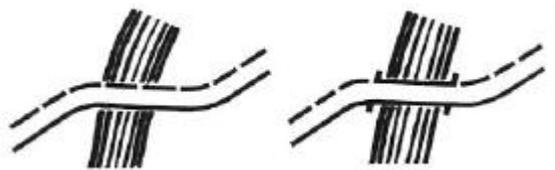
Ilustración 1.3.28: Un puente de carretera no deberá ser representado por línea a trazos.
