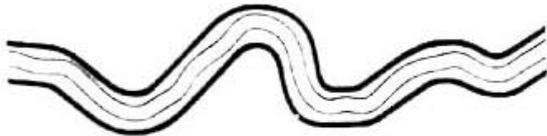
Ilustración 1.3.13: Se eliminarán pequeñas irregularidades que serán cubiertas por el ancho de línea en la reducción.
