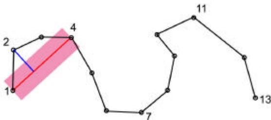
Ilustración 3.2.10: La distancia desde el punto 2 a la línea que une el primer punto y el punto 4 sigue superando el umbral por lo que se vuelve a subdividir por este punto.
