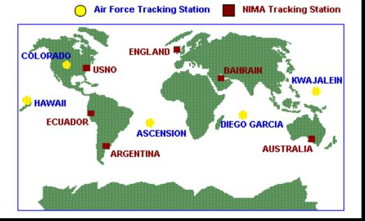
Mediante una serie de estaciones de monitoreo se realiza el calculo y corrección de los relojes de los satélites y de las efemérides.
