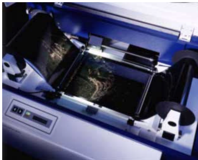
Ilustración 3.33: Alimentador de rollo automático del escáner PhotoScan 2001 de ZI Imaging
